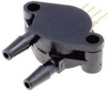
**Figura 13.** Sensor de presión MPX4250AP.
