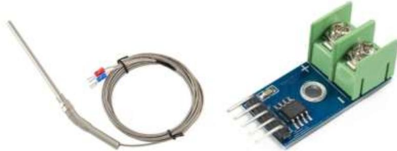
**Figura 12.** Termopar Tipo K con módulo MAX6675.
