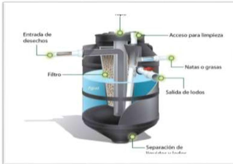
**Figura 6:** Esquema de un biodigestor.
