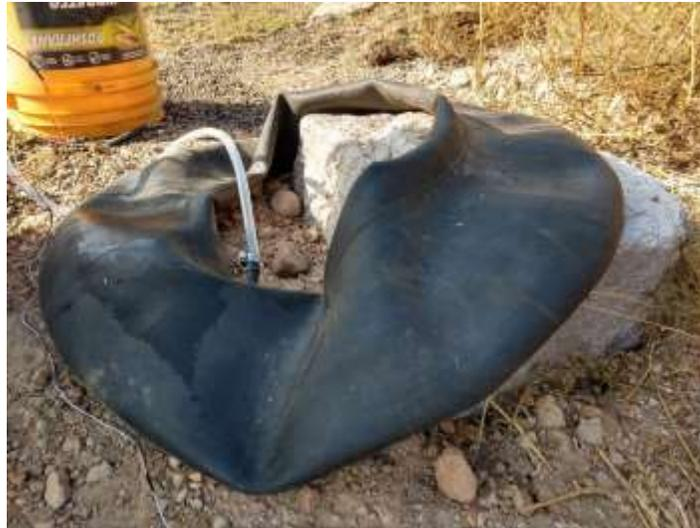
**Figura 22.** Receptor de biogás acumulado.
