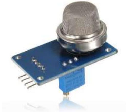
**Figura 15.** Sensor de gas MQ-4.
